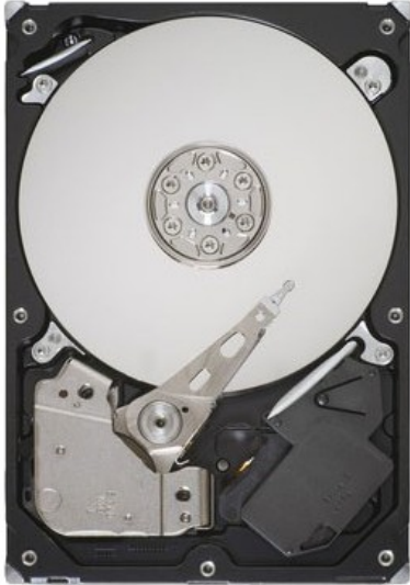
Disque dur mécanique avec des plateaux en rotation et des têtes de lecture. C'est l'élément le plus ralentissant d'un ordinateur.
